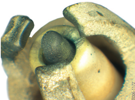
37 - Schadbild einseitiger Elektrodenabbrand
