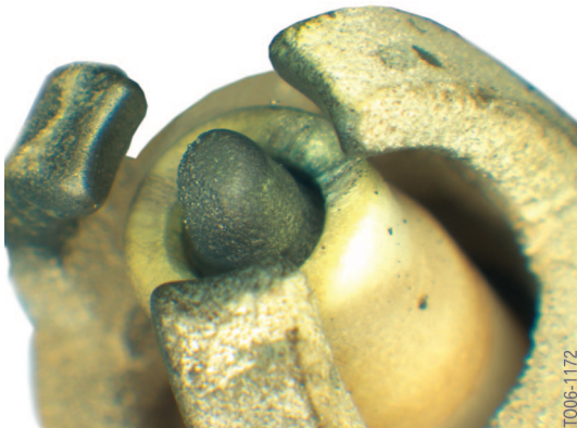
2 - Schadbild einseitiger Elektrodenabbrand
